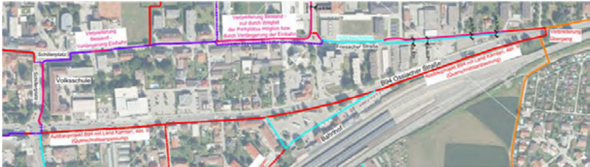
Die B94 Ossiacher Straße (Villacher Straße) soll im Bereich vom Schillerplatz bis zum bestehenden Übergang des überregionalen Radweges R7 im Zuge im Zuge eines Ausbauprojektes mit dem Land Kärnten, Abteilung 9, mittels Querschnittsanpassung angepasst und verbreitert werden. Der bestehende Übergang östliche des Bahnhofbereiches soll verbreitert werden.
